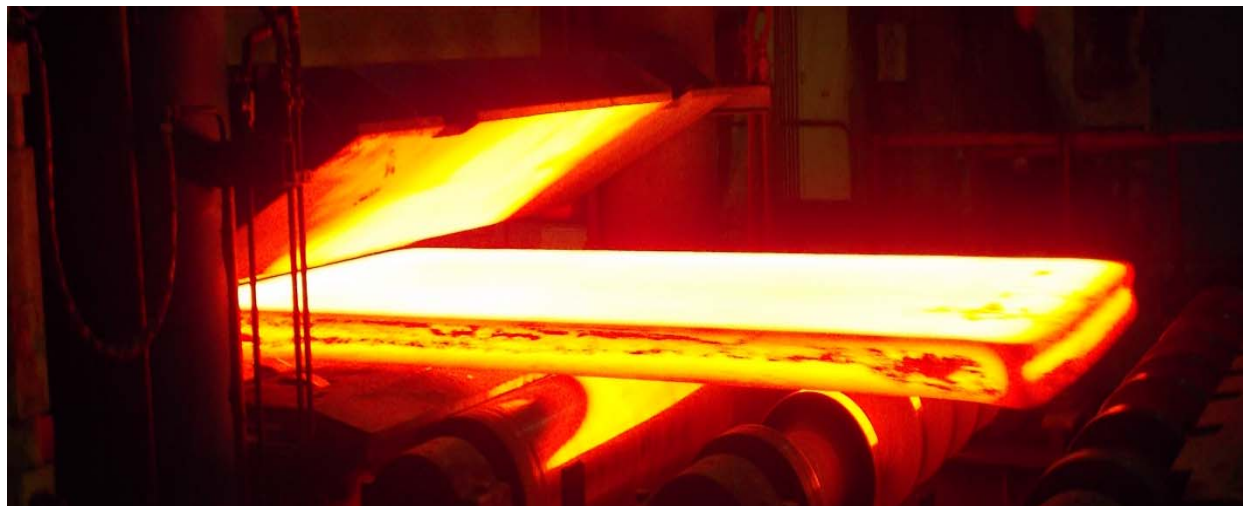
Рис. 2. Горячая правка листа из стали 3сп толщиной 100 мм при температуре 850 °С
