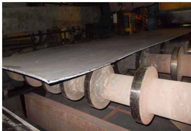
Рис. 3. Холодная правка листов из стали 09Г2С: а – толщина 16 мм; б – толщина 8 мм
