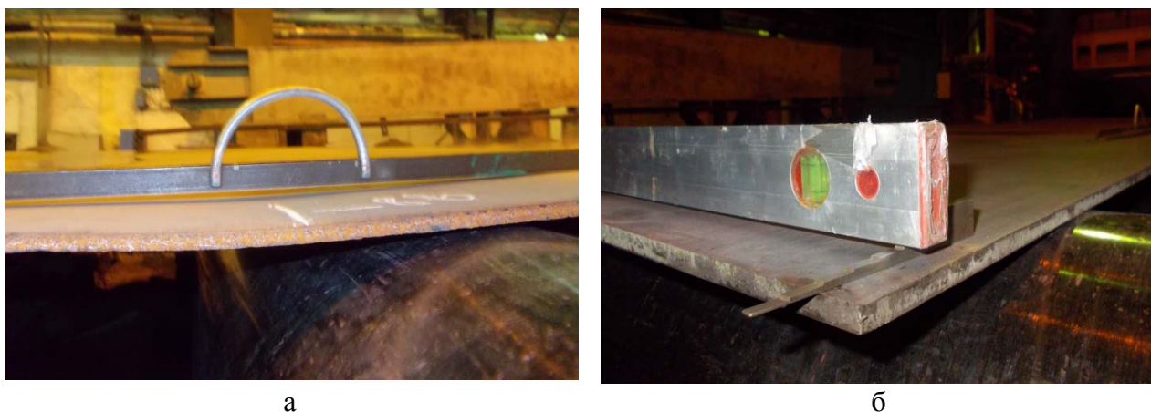
Рис. 4. Замеры толщины выправляемого металла и исходных дефектов плоскостности: а – волнистости; б – коробоватости
