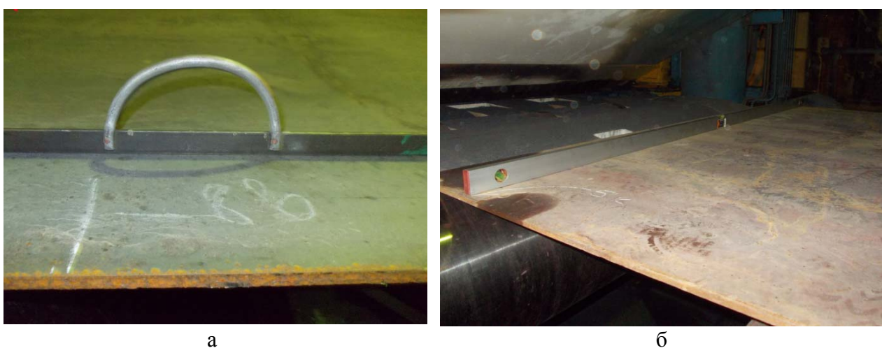
Рис. 5. Замеры дефектов плоскостности листа после правки: а – волнистости; б – коробоватости
